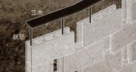
壁自体を曲げることで壁の強度を高める
